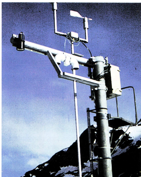
Figure 7.8 Station de mesure automatique rendant possible la mesure en continu et en temps réel de nombreuses données nivo-météorologiques.
