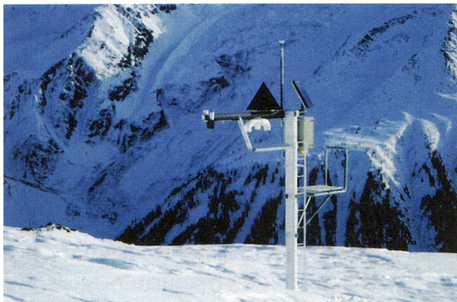
Figure 7.2 Station automatique « nivöse ». La hauteur de neige, la température et la vitesse du vent sont mesurées toutes les heures et sont transmises via satellite.
